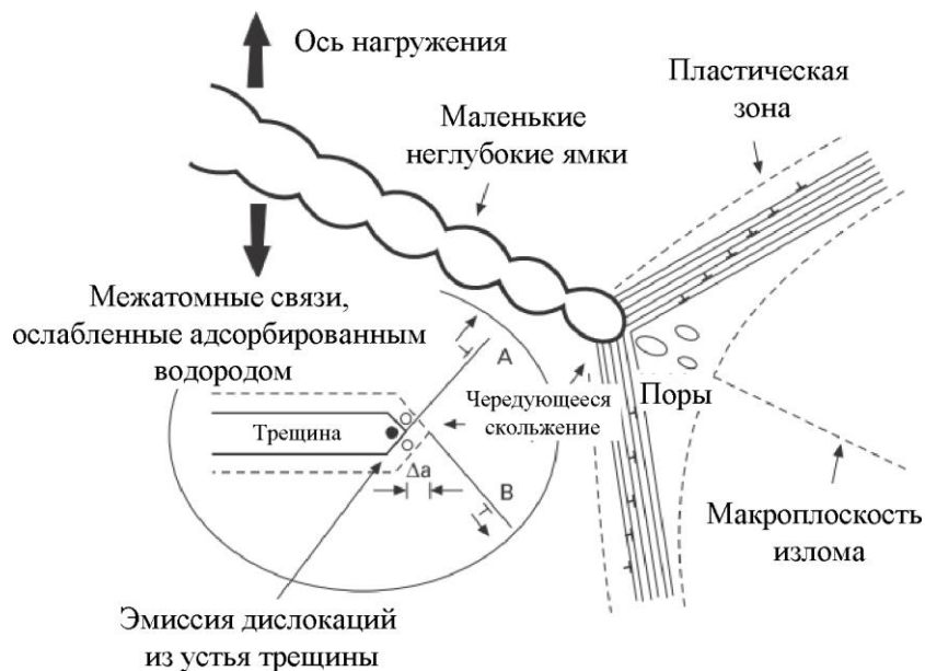
Рисунок 1.8 – Схематическая иллюстрация механизма адсорбционно-индуцированной дислокационной эмиссии (AIDE) [110]
