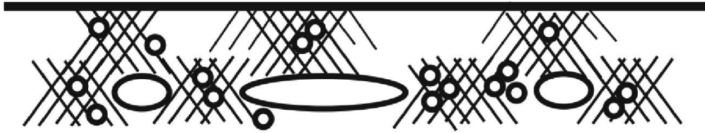
Рисунок 1.9 – Схематичная иллюстрация механизма вакансионного механизма ВХ (HESIV) [29]
